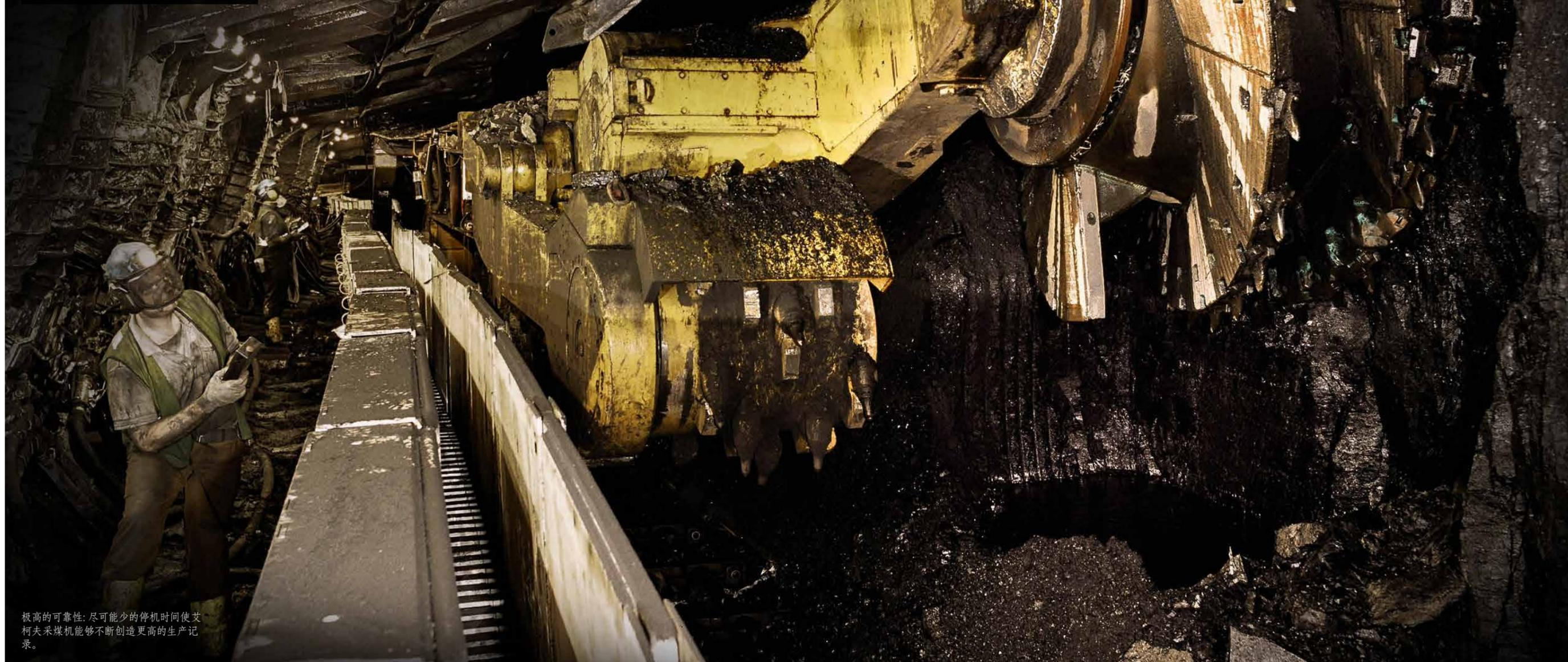
极高的可靠性：尽可能少的停机时间使艾柯夫采煤机能够不断创造更高的生产记录。
