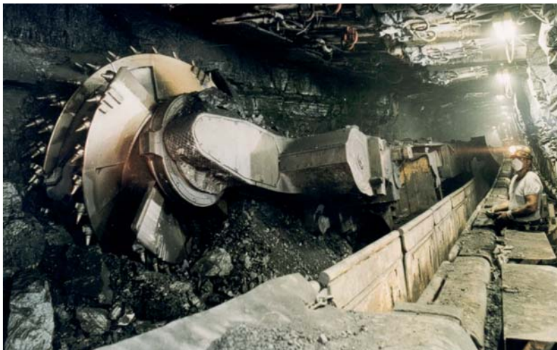
Die Eickhoff Bergbautechnik entwickelt, produziert und vertreibt Hochleistungsmaschinen für den untertägigen Bergbau. Im Bild ein Schrägwalzenlader.
